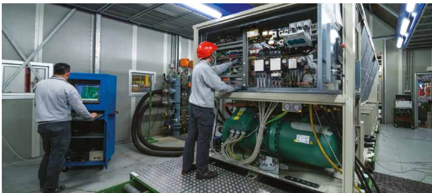
Le cabine dei Witness test sono state studiate per ottimizzare l'affidabilità dei test condotti sull'unità, assicurando che vengano simulate le condizioni di installazione reali per controllare le prestazioni garantite dell'unità.
