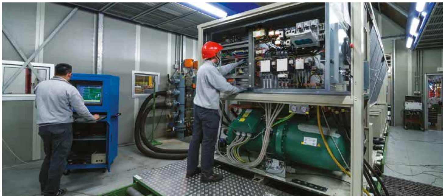
Kabiny do samodzielnego testowania zostały zaprojektowane z myślą o przeprowadzaniu rzetelnych testów urządzeń w rzeczywistych warunkach pracy, dzięki czemu klient może upewnić się, że urządzenie pracuje z deklarowaną wydajnością.
