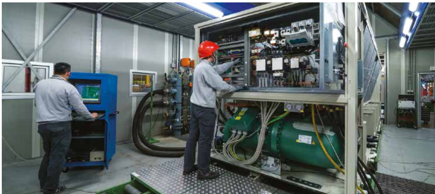
Камеры для испытаний в присутствии клиента обеспечивают максимально надежное тестирование устройств, предоставляя возможность реального моделирования условий и подтверждения заявленных показателей производительности устройства.
