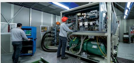
L'area di convalida dei chiller freecooling è in grado di gestire un carico termico fino a 1600 kW con una temperatura dell'aria nella sala compresa tra 20 e 50 °C e un set-point dell'acqua refrigerata compreso tra 5 e 20 °C.
