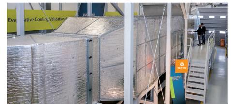
Area dedicata alle prove di Liebert EFC, l'unità di freecooling evaporativo indiretto ad alta efficienza di Vertiv. I parametri di prova comprendono carichi IT fino a 450 kW e una portata aria fino a 120.000 m<sup>3</sup>/ora con qualsiasi temperatura ambiente esterna richiesta, per simulare le condizioni di picco tipiche di tutta EMEA.
