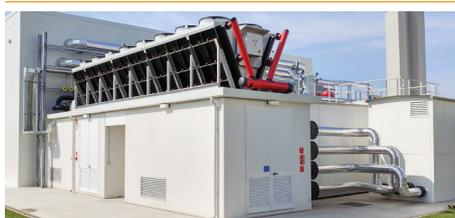
Ce laboratoire récemment conçu peut tester des unités ayant des puissances frigorifiques allant jusqu'à 1,5 MW avec une précision de pointe dans une large variété de conditions opérationnelles, de -10 °C à +55 °C, idem pour des unités adiabatiques.
