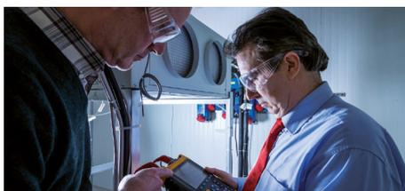
Conçu pour des refroidisseurs du secteur des télécoms, le laboratoire de validation de Recherche et Développement n°2 regroupe deux espaces de tests distincts : l'un simule des conditions ambiantes internes comprises entre 0 °C et 60 °C et l'autre des conditions ambiantes extérieures allant de -32 °C à 60 °C. Cette zone de validation peut équilibrer une charge thermique jusqu'à 100 kW (50 kW dans chaque salle).
