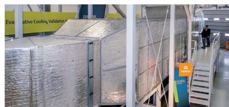
Area dedicata alle prove di Liebert EFC, l'unità di freecooling evaporativo indiretto ad alta efficienza di Vertiv. I parametri di prova comprendono carichi IT fino a 450 kW e una portata aria fino a 120.000 m<sup>3</sup>/ora con qualsiasi temperatura ambiente esterna richiesta, per simulare le condizioni di picco tipiche di tutta EMEA.
