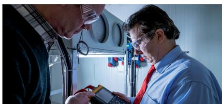
Conçu pour des climatiseurs du secteur des télécoms, le laboratoire de validation de Recherche et Développement n°2 regroupe deux espaces d'essais différents : l'un simule des conditions ambiantes internes comprises entre 0 °C et 60 °C et l'autre simule des conditions ambiantes extérieures allant de -32 °C à 60 °C. Cette zone de validation peut équilibrer une charge thermique jusqu'à 100 kW (50 kW dans chaque salle).
