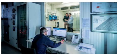
Le laboratoire de validation de Recherche & Développement n°1 a été spécifiquement pensé pour tester les unités périphériques ; il peut équilibrer une charge thermique allant jusqu'à 150 kW avec une température ambiante comprise entre 0 °C et 60 °C.
