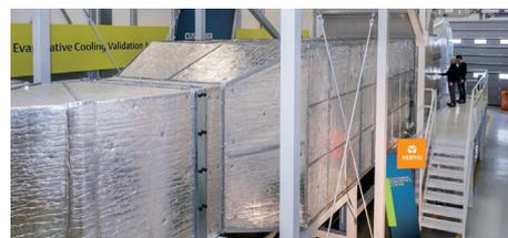
Espace dédié pour tester le Liebert EFC, l'unité de freecooling par évaporation indirecte à haut rendement de Vertiv. Les paramètres de test intègrent des charges IT allant jusqu'à 450 kW et un débit d'air allant jusqu'à 120 000 m³ par heure, quelle que soit la température ambiante extérieure requise pour simuler les conditions de pointe typiques que l'on peut rencontrer dans l'ensemble de la zone EMEA.
