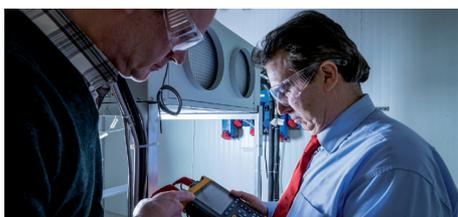
Concebido para aparelhos de ar condicionado que pertencem ao setor das telecomunicações, o laboratório de validação de investigação e desenvolvimento n.º 2 inclui duas câmaras de teste diferentes: uma que simula as condições ambiente internas de 0 °C a 60 °C e outra que simula as condições ambiente externas de -32 °C a 60 °C. Esta área de validação consegue equilibrar uma carga térmica de até 100 kW (50 kW em cada sala).
