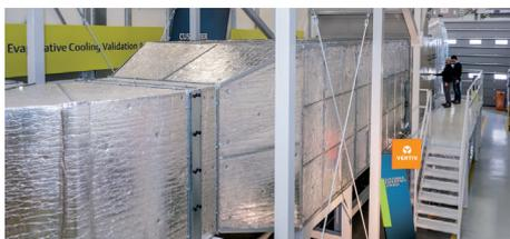
Área dedicada para testar a unidade de freecooling evaporativo indireto altamente eficiente do Liebert EFC, a unidade de freecooling evaporativo indireto altamente eficiente da Vertiv. Os parâmetros de teste incluem cargas de TI de até 450 kW e um fluxo de ar de até 120 000 m<sup>3</sup> por hora, numa temperatura ambiente externa necessária para simular condições de pico típicas na região EMEA.
