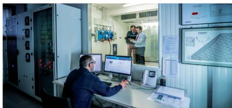
O laboratório de validação de investigação e desenvolvimento 1 foi concebido especificamente para testar unidades de chão e consegue equilibrar uma carga térmica de até 150 kW com uma temperatura do ar em câmara entre os 0 °C e os 60 °C.
