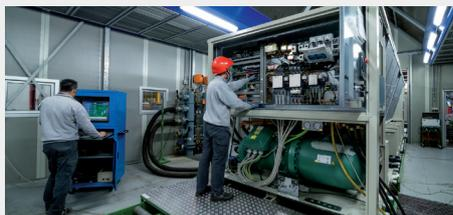
A área de validação do chiller de freecooling consegue equilibrar uma carga térmica de até 1600 kW com uma temperatura de ar em câmara de entre 20 °C e 50 °C e um ponto de arrefecimento da água entre 5 °C e 20 °C.
