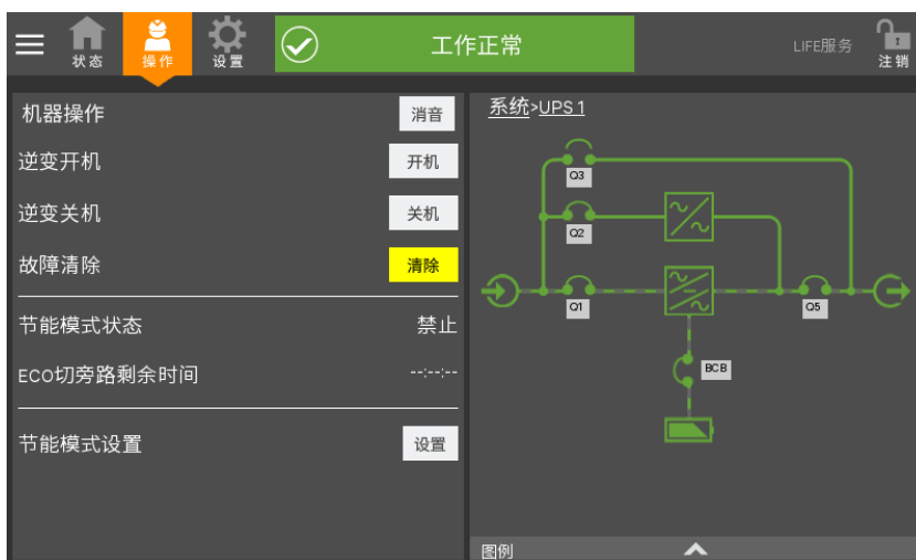
图5-8 切换 UPS 至正常模式
