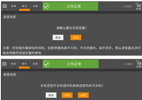
图 4-14 单机、并机逆变关机命令
