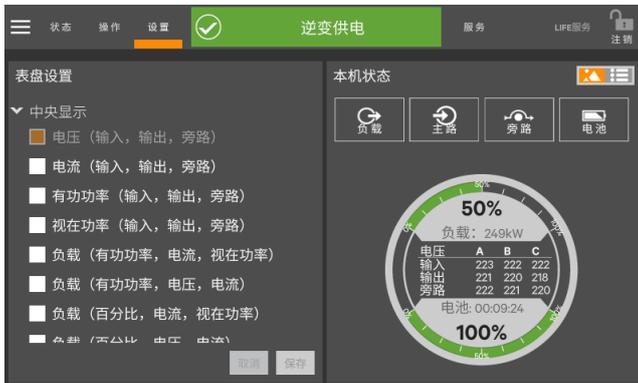
图 4-20 状态表盘中央显示设置
