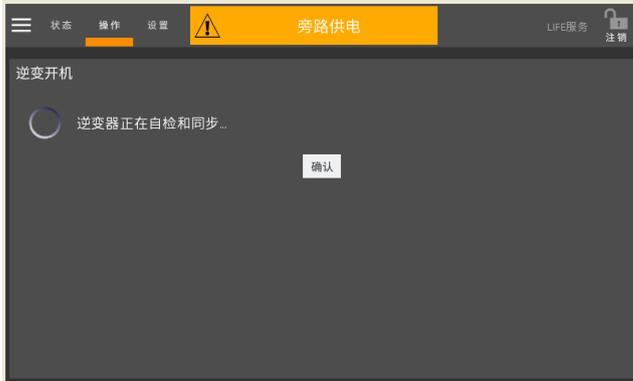
图 5-4 逆变器自检和同步
