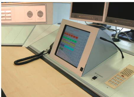
Neigungsverstellung für integrierte Monitore
