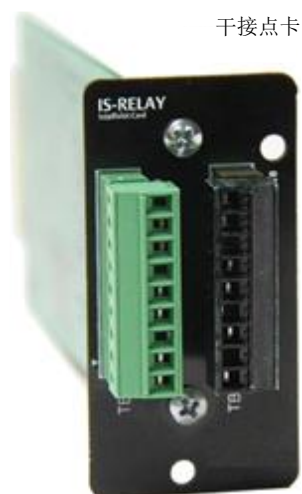
图8-4 IS-RELAY 卡外观图
