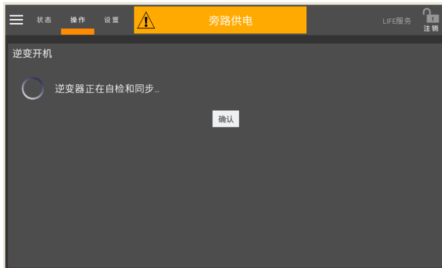
图5-4 逆变器自检和同步
