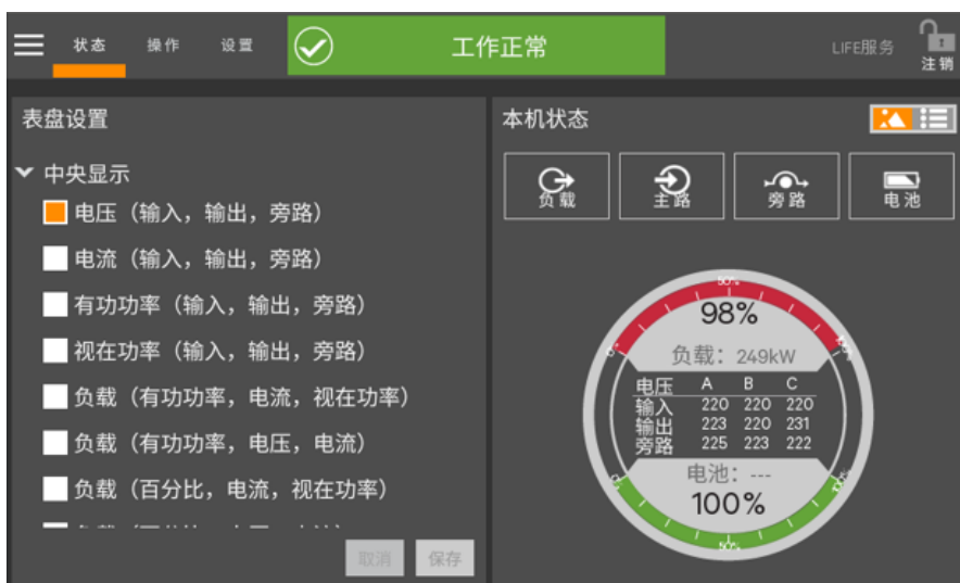
图4-22 状态表盘中央显示设置
