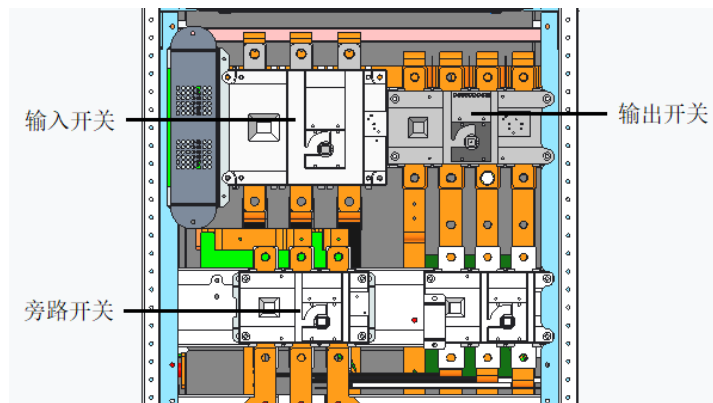
图8-6 输入输出开关组件位置示意图
