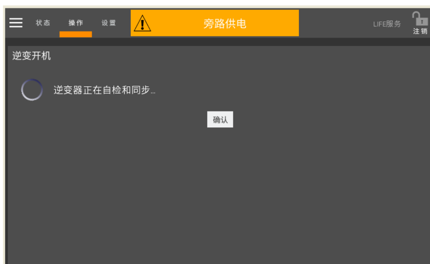
图5-4 逆变器自检和同步
