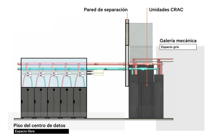
Los sistemas de enfriamiento por aire que dan servicio a los sistemas de TI en el espacio libre pueden penetrar la galería a través de conductos o cortes en las paredes. Según el diseño, estas zonas, las cuales permiten la circulación del aire, pueden necesitar compuertas cortafuegos.
