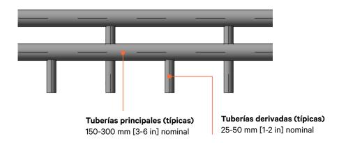
Los diseños debajo del piso para las tuberías deben dejar espacio suficiente para las tuberías, el aislamiento y el cruce de tuberías. Las dimensiones serán diferentes de un sitio a otro.
