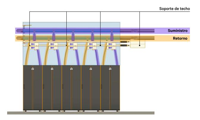
Esta ilustración muestra un distribuidor de suministro y retorno de líquido y barra de alimentación suspendidos.
