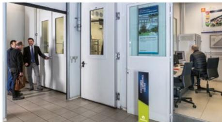
A área de validação da unidade de chão cumpre os requisitos crescentes dos testes com presença de observador e as aprovações específicas do tipo de produto. Equipada com uma câmara de testes automatizada, esta área de validação tem capacidade para equilibrar uma carga térmica de até 200 kW e simular um ambiente de teste num intervalo de temperatura compreendido entre 0 °C e 60 °C.
