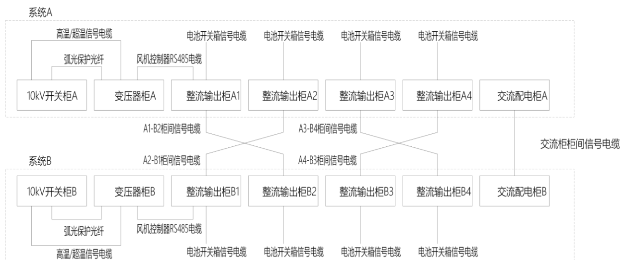
图1-6 电源系统信号电缆连接示意图
