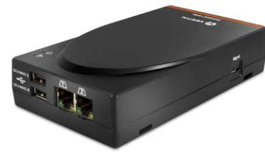
L'accès à distance aux dispositifs IT reste un besoin croissant sur le marché Edge. L'empreinte des équipements informatiques, de réseau et de stockage continue d'augmenter. Le module d'interface Avocent® IPSL IP Serial Device est une extension de la plateforme Avocent® DSView™ et offre c'est une partie d'Avocent DSView Solution.
