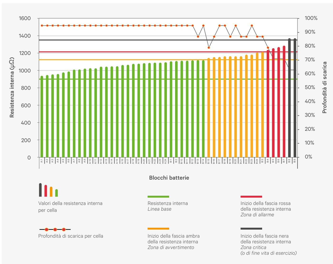
Figura 2. Dati di scarica e resistenza interna in ordine crescente
