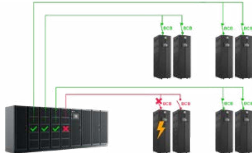
Figura 7. Si el BCB no puede corregir el fallo de las baterías, el fallo se localizará dentro de un solo circuito de baterías.
