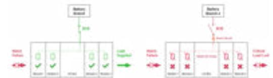
*Figura 13. Escenario con sistema de baterías centralizadas que muestra la condición inicial (izquierda) y después de un cortocircuito entre el BCB y el UPS (pérdida de carga crítica, a la derecha)*
