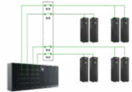
Figura 11. Em configurações de baterias distribuídas, diversos BCBs permitem que grupos de baterias operem de forma independente. Isso significa que um problema com um BCB não afeta todo o sistema de energia de backup, permitindo que as outras baterias respaldem a carga do banco de baterias que falhou.
