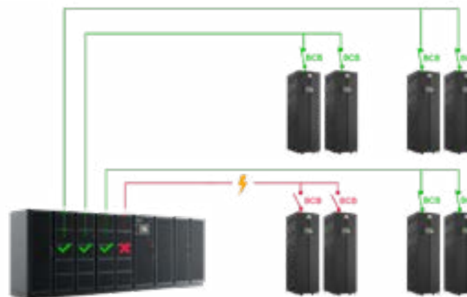
Figura 12. Uma comparação dos sistemas de baterias centralizadas (superior) e sistemas distribuídos (inferior) durante cenários reais de falha da rede elétrica.
