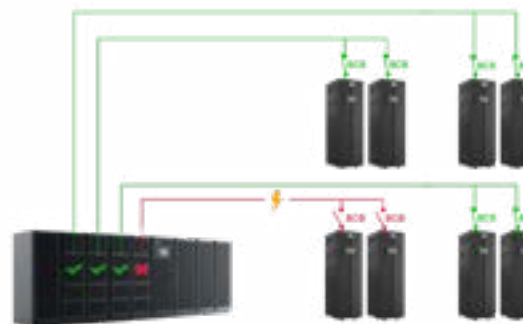
Figura 5. Com baterias distribuídas, apenas o grupo de baterias afetado ficará indisponível no caso de um curto circuito entre o BCB e o UPS. As baterias restantes continuarão a estar disponíveis para energia de backup.
