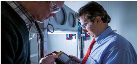
Dedicado a las unidades de aire acondicionado destinadas al sector de telecomunicaciones, el laboratorio de I+D para validación n.º 2 cuenta con dos cámaras de prueba distintas: una para la simulación de condiciones ambientales interiores, con temperaturas de entre 0 y 60 °C, y otra para la simulación de condiciones ambientales exteriores, con temperaturas de entre -32 y 60 °C. Esta zona de validación tiene capacidad para equilibrar una carga térmica de hasta 100 kW (50 kW para cada sala).
