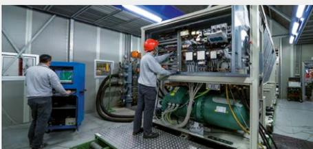
La zona de validación de chillers de freecooling puede equilibrar una carga térmica de hasta 1600 kW con una temperatura del aire de la cámara de entre 20 y 50 °C y un punto de consigna del agua de la enfriadora de entre 5 y 20 °C.
