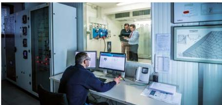
Questo laboratorio destinato alla ricerca e sviluppo, è stato progettato per provare le unità perimetrali e può gestire un carico termico fino a 150 kW, con una temperatura ambiente dell'aria compresa tra 0 e 60 °C.
