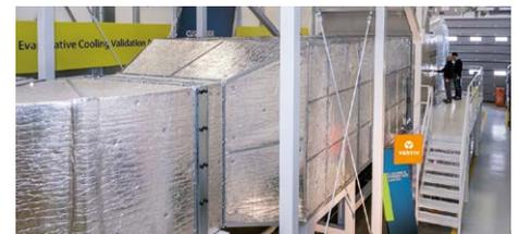
Area dedicata alle prove di Liebert EFC, l'unità di freecooling evaporativo indiretto ad alta efficienza di Vertiv. I parametri di prova comprendono carichi IT fino a 450 kW e una portata aria fino a 120.000 m³/ora con qualsiasi temperatura ambiente esterna richiesta, per simulare le condizioni di picco tipiche di tutta EMEA.
