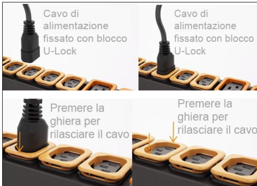
Figura 2.15 Funzionamento del fermocavo U-Lock
