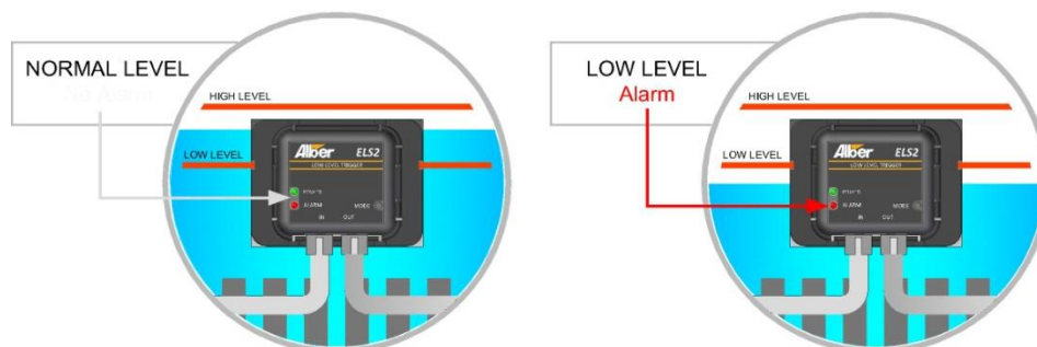
Figure 12 - ELSi 2 Interface and ELS 2 Sensor Module Configuration Diagram
