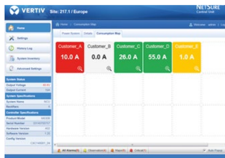
Carte de la consommation électrique montrant la puissance agrégée pour chaque client sur des sites de colocation partagés/hébergés.
