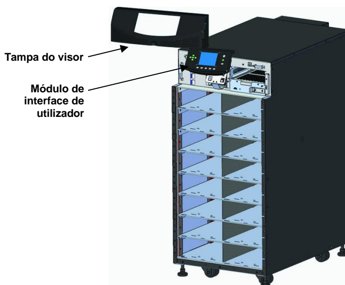
Figura 24: Remoção da tampa de plástico grande e do módulo de interface de utilizador
