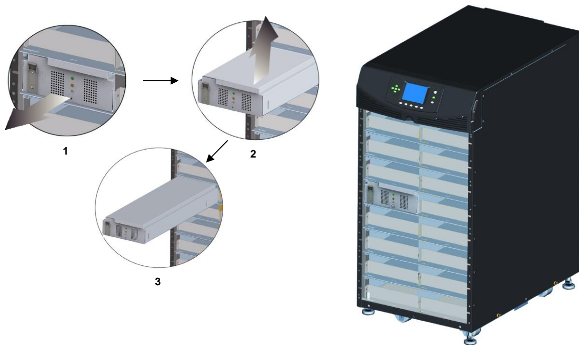
Figura 57: Remoção de um módulo de baterias, um módulo de potência ou um módulo de carga
