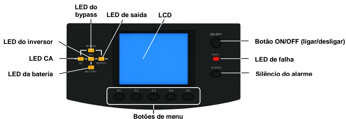
Figura 39: Disposição do módulo de interface de utilizador
