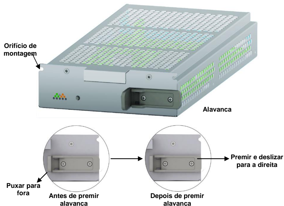
Figura 26: Alavanca e dispositivo de fixação dos módulos de controle do sistema e de monitorização do sistema
