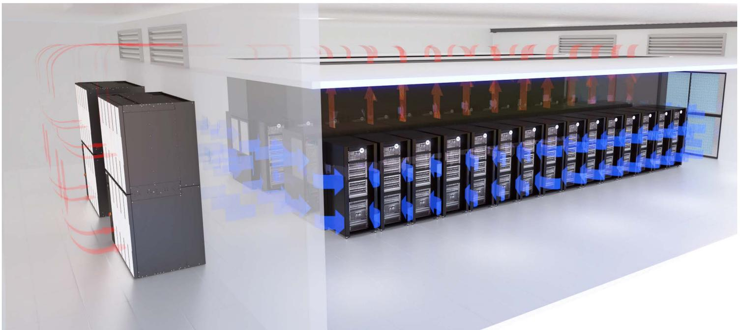
**Evaluar las especificaciones del diseño de las salas de computadoras:** los equipos deben definir la ubicación de la unidad de enfriamiento en la sala, evaluar la colocación del pasillo de servidores y considerar las dimensiones y la altura de la sala de TI, así como el espacio del pasillo de servicio y la ubicación de los conductos de aire de retorno.
