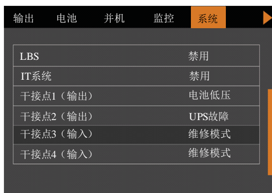
图5-7 确认干接点 3 为“维修模式”
