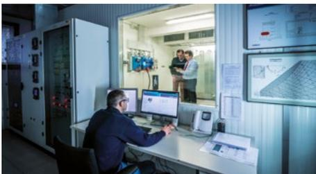
Der Prüfbereich 1 für Forschung und Entwicklung wurde speziell für Klimageräte entwickelt. Darin kann eine Wärmelast von bis zu 150 kW bei einer Kammerlufttemperatur von 0°C bis 60°C erzeugt werden.
