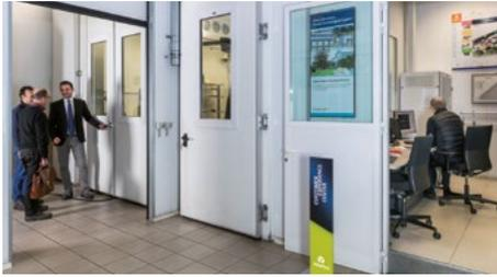
Der Prüfbereich für Klimageräte erfüllt den wachsenden Bedarf an Tests im Beisein von Kunden („Witness Tests“) und spezielle Produktfreigaben. Mit einer hochautomatisierten Testkammer ausgestattet, kann in diesem Prüfbereich eine Wärmelast von bis zu 200 kW erzeugt und ein Temperaturbereich von 0°C bis 60 C simuliert werden.
