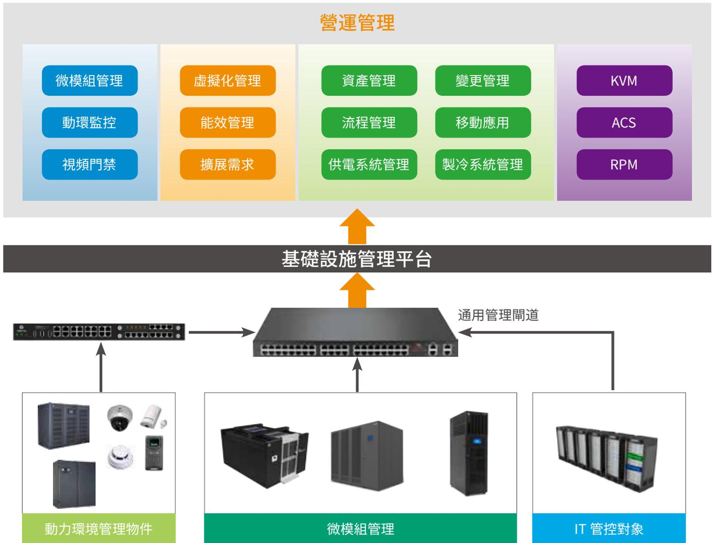
SmartAisle 2 系統融合方面將進一步推進網路化、分散式的智慧融合，將 SmartSolutions 的基礎架構整合到資料中心物理支撐當中。從總部到分公司，滿足客戶各種需求。
