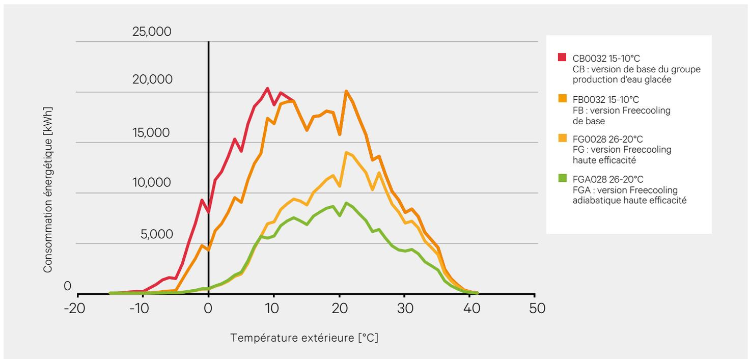
Profil climatique de Madrid avec une charge thermique de 350 kW
