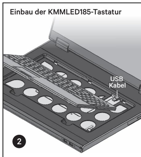
die Tastaturfassung des Konsolen-Trays drücken. Drücken Sie die Tastatur in Position.
