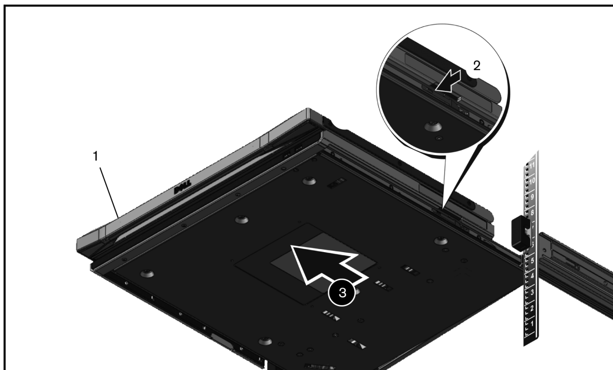
Рис. 4.1 Извлечение лотка консоли из стойки
